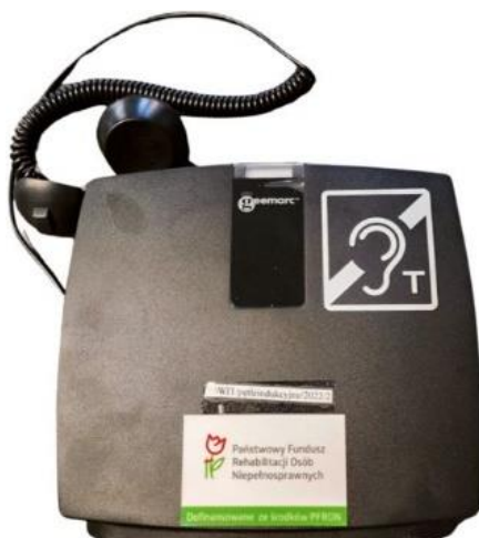
Przenośna pętla indukcyjna, model Geomarc LoopHEAR LH102 V2 (Źródło: Ośrodek Wsparcia i Testów w Skarżysku-Kamiennej)
