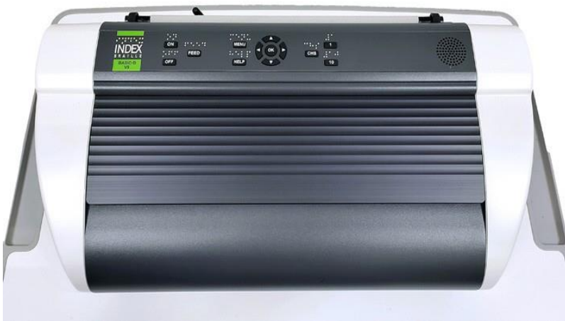
Drukarka brajlowska, model Basic-D V5 (Źródło: Ośrodek Wsparcia i Testów w Skarżysku-Kamiennej)
