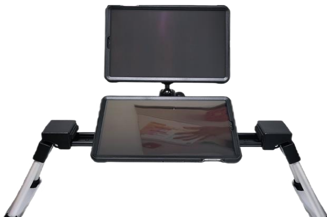
Przenośny powiększalnik z dwoma ekranami, model Exigo (Źródło: Ośrodek Wspierania i Testów w Skarżysku-Kamiennej)
