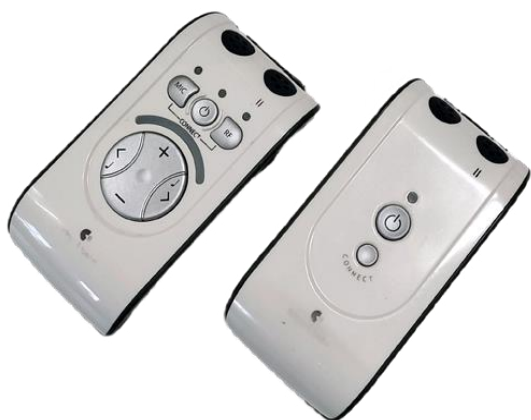
Bezprzewodowy system wspomagania słyszenia, model Domino Classic (Źródło: Ośrodek Wsparcia i Testów w Skarżysku-Kamiennej)
