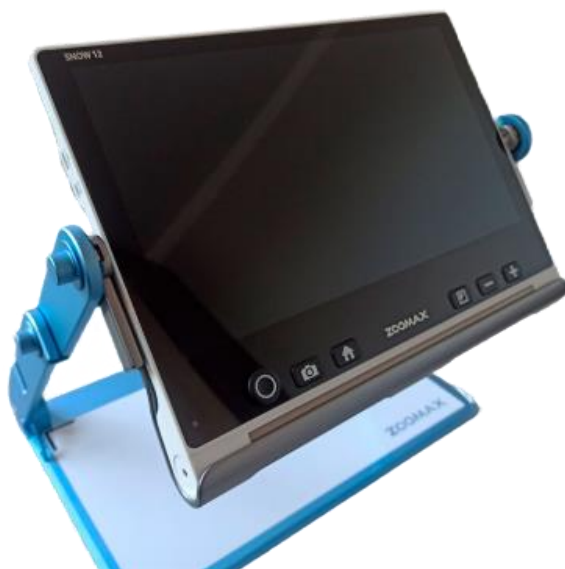
Lupa elektroniczna, model Snow 12 (Źródło: Ośrodek Wsparcia i Testów w Łodzi, strona internetowa: https://www.owit-lodz.pl/wyposzczalnia/ )
