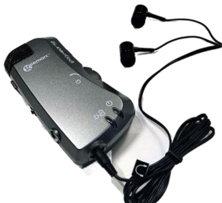
Osobisty wzmacniacz dźwięku z odbiornikiem pętli indukcyjnej, model Geemarc LoopHEAR LH10 (Źródło: Ośrodek Wsparcia i Testów w Skarżysku--Kamiennej)
