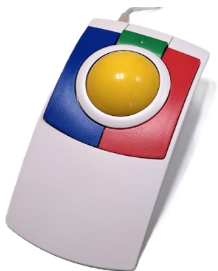
Specjalistyczna mysz komputerowa typu trackball, model KidTrac (Źródło: Ośrodek Wsparcia i Testów w Skarżysku--Kamiennej)
